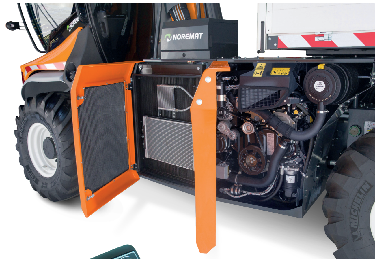
Capotages sur charnières pour un accès immédiat aux compartiments moteur et refroidisseurs
