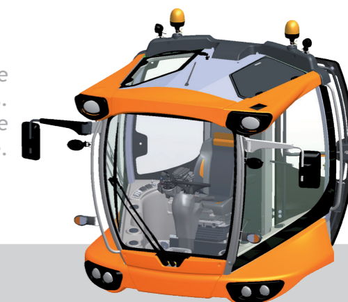
Vision panoramique intégrale sur les outils de coupe, sur le profil de l'accotement et sur le trafic environnant.
